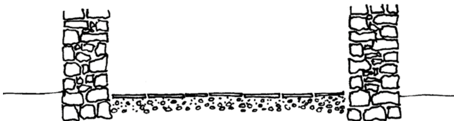
Presjek poda od kamenih ploča
